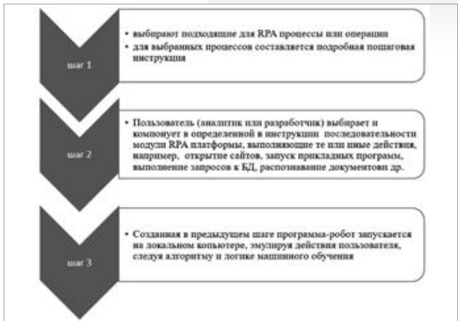
Рис. 1. Создание и общий принцип работы программы-робота.
